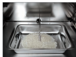
Objekttemperaturanzeige mittels PT 100 Fühler
