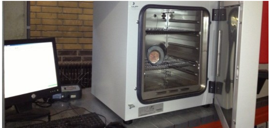
▲ Beschleunigter Alterungsprozess von Kabel
